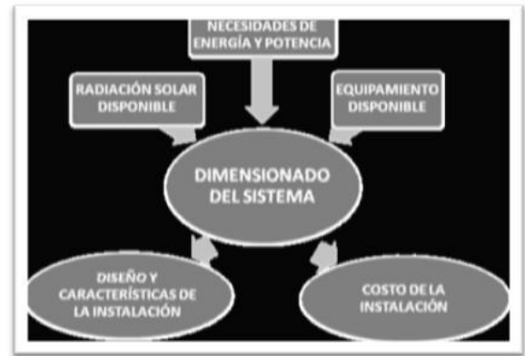
Figura 3. Elementos que intervienen en el diseño de un sistema fotovoltaico.
